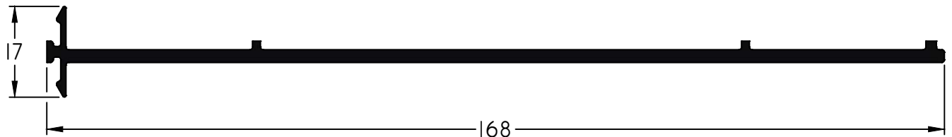
701 - Acople 3 guías Largo Std.: 6150 mm peso: 1,16 Kg/m
